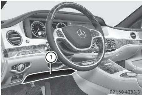
L'airbag de genoux côté conducteur ① se déploie en dessous de la colonne de direction. L'airbag de genoux côté conducteur se déclenche en même temps que les airbags frontaux.
