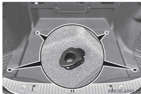
4 crochets du filet à bagages sont disposés dans le coffre.
