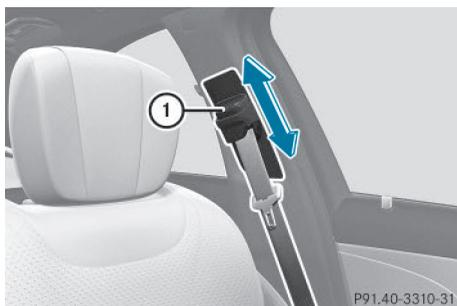
La partie supérieure de la ceinture doit toujours passer sur le milieu de l'épaule. Si nécessaire, réglez le point de renvoi de la ceinture.
