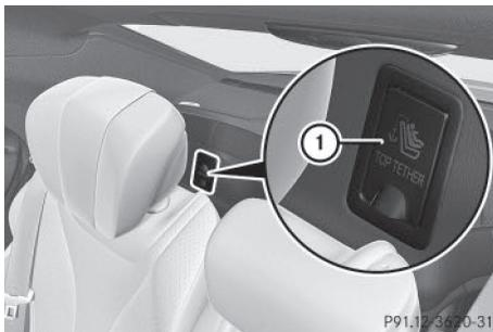
Les points d'ancrage Top Tether sont montés à l'arrière, derrière les appuie-tête sur la plage arrière.
