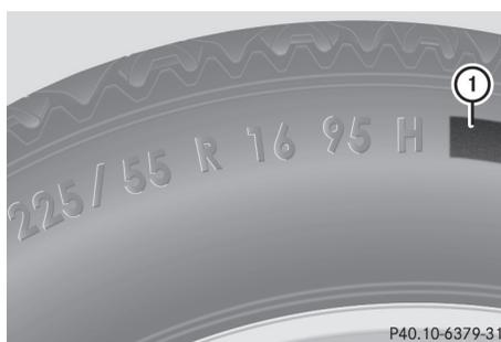
En plus de l'indice de charge, le flanc du pneu peut porter un code de charge ①. Celui-ci est
