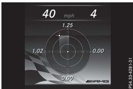
L'accéléromètre (G-Meter) affiche les forces qui s'exercent sur le conducteur dans le sens longitudinal et transversal pendant la marche.
