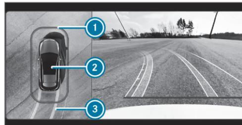
Vue du dessus avec image fournie par la caméra avant ou la caméra de recul
