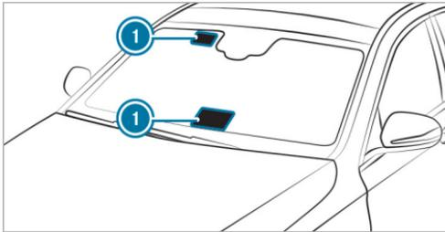
Montez uniquement les appareils commandés par radio, tels que les systèmes de télépéage, dans les zones du pare-brise laissant passer les ondes radio ❶.
