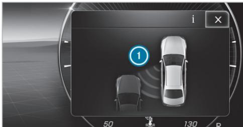
Lorsqu'une intervention de freinage permettant de corriger la trajectoire a lieu, le voyant rouge d'alerte intégré au rétroviseur extérieur clignote et un signal d'alerte retentit. En outre, un affichage (1) signalant un risque de collision latérale apparaît sur l'écran conducteur.
