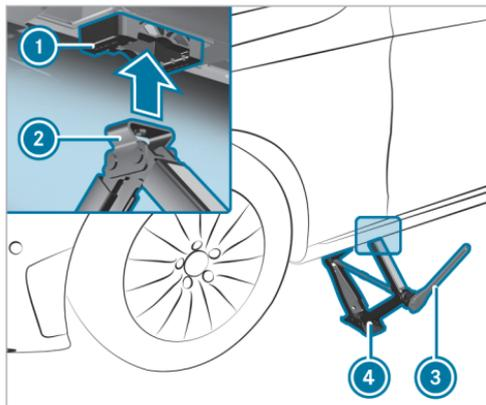
► Placez l'appui ② du cric ④ sous le point d'appui du cric ①.
