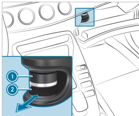
► **Insertion :** poussez le flacon ② dans le support jusqu'en butée.
