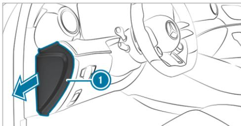
La boîte à fusibles se trouve du côté conducteur, sous un cache, à l'extrémité du poste de conduite.
