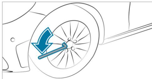
▶ A l'aide de la clé démonte-roue, dévissez les vis de la roue à changer de 1 tour environ. Ne dévissez pas complètement les vis.
