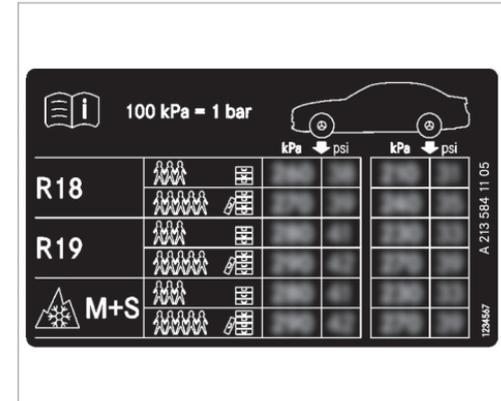
Certains tableaux de pression des pneus mentionnent uniquement le diamètre des jantes (R18, par exemple) à la place des dimensions de pneus complètes. Le diamètre des jantes est indiqué dans les dimensions des pneus et figure sur le flanc des pneus (→ page 379).
