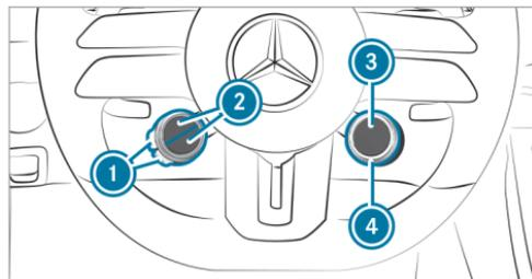
Les touches du volant AMG se composent de 2 éléments de commande supplémentaires sur le volant.
