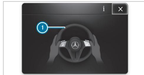
Si le système détecte que le conducteur ne dirige pas lui-même le véhicule ou qu'il lâche le volant pendant une période prolongée, l'affichage **1** apparaît. Si le conducteur ne dirige toujours pas activement le véhicule ou ne donne pas de signal de confirmation au système, un signal d'alerte retentit de façon répétée en plus de l'alerte optique.
