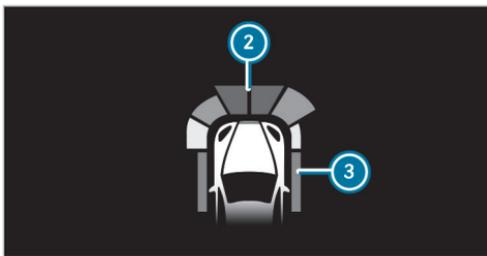
Les obstacles détectés par l'assistant de stationnement PARKTRONIC se trouvant à moins de 3,3 ft (1,0 m) environ à l'avant ② et 2,3 ft (0,7 m) environ sur les côtés ③ peuvent, en option, également apparaître dans l'affichage tête haute.
