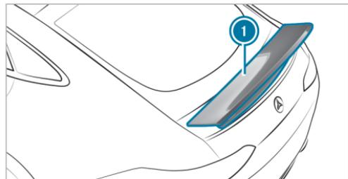
L'aileron arrière ❶ améliore la stabilité de marche du véhicule et rentre et sort automatiquement pendant la marche. En fonction du programme de conduite sélectionné et de la vitesse à laquelle vous roulez, l'aileron arrière se place dans différentes positions et modifie ainsi l'aérodynamisme de votre véhicule en fonction des conditions de marche.
