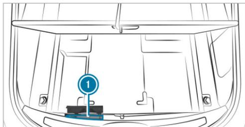
L'anneau de remorquage se trouve sous le plancher de compartiment de chargement, sous un cache ①.
