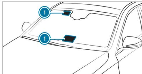
Montez uniquement les appareils commandés par radio, tels que les systèmes de télépéage, dans les zones du pare-brise laissant passer les ondes radio ①.
