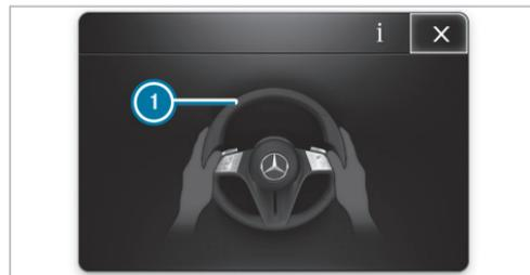
Si le système détecte que le conducteur ne dirige pas lui-même le véhicule ou qu'il lâche le volant pendant une période prolongée, une alerte optique se déclenche d'abord. L'affichage ① apparaît sur l'écran conducteur. Si le conducteur ne dirige toujours pas activement le véhicule ou ne donne pas de signal de confirmation au système,
