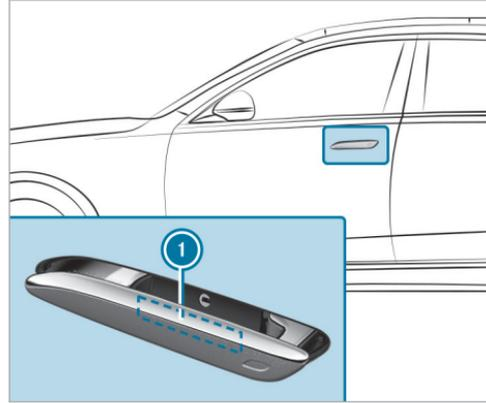
▶ **Déverrouillage du véhicule** : lorsque la poignée de porte est sortie, touchez le côté intérieur de la poignée de porte ①.
