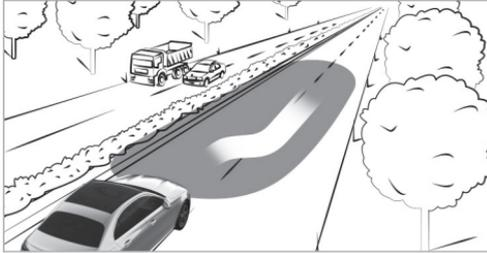
A une vitesse égale ou supérieure à 19 mph (30 km/h), le tracé du changement de voie est signalé par un clignotement en cas de changement de voie assisté.
