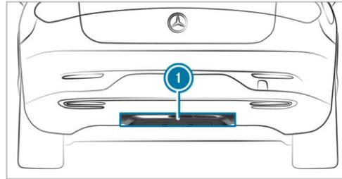
**1** Zone de détection des capteurs
