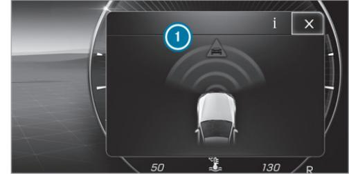
Lorsqu'un freinage autonome ou une amplification de la force de freinage asservie à la situation a été déclenché, la fenêtre contextuelle ❶ apparaît sur l'écran conducteur, puis disparaît automatiquement après un court instant.
