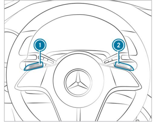
**i** Au redémarrage du véhicule, **D** est automatiquement réglé comme niveau de récupération.
