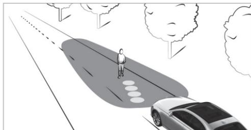
La fonction Spotlight fonctionne en arrière-plan et signale par quatre brefs clignotements des phares les personnes détectées à l'intérieur de la ligne de délimitation de la voie. Le conducteur est aussi averti par une projection du symbole sur la position de la personne.
