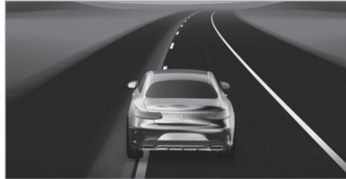
Si vous passez sur une ligne de délimitation de la voie détectée avec une roue avant, la ligne est mise en évidence en rouge dans le menu **Assistance** sur l'écran conducteur.
