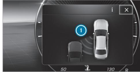
Lorsqu'une intervention de freinage permettant de corriger la trajectoire a lieu, le voyant rouge d'alerte intégré au rétroviseur extérieur clignote et un signal d'alerte retentit. En outre, un affichage ① signalant un risque de collision latérale apparaît sur l'écran conducteur.
