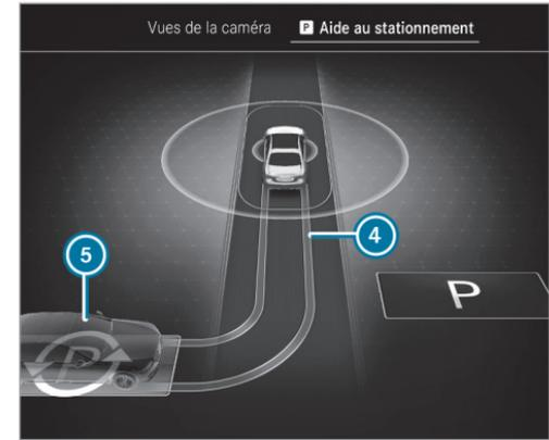
Lorsque le véhicule est à l'arrêt, la trajectoire visée **4** pour entrer dans la place de stationnement actuellement sélectionnée **5** est également affichée.
