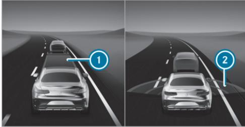
Dans le menu **Assistance**, une distance insuffisante ❶ par rapport au véhicule qui précède est représentée en rouge. Si vous réduisez la distance encore davantage, le véhicule qui précède est également affiché en rouge. Si un risque de collision est détecté, des ondes radar rouges ❷ apparaissent devant le véhicule.
